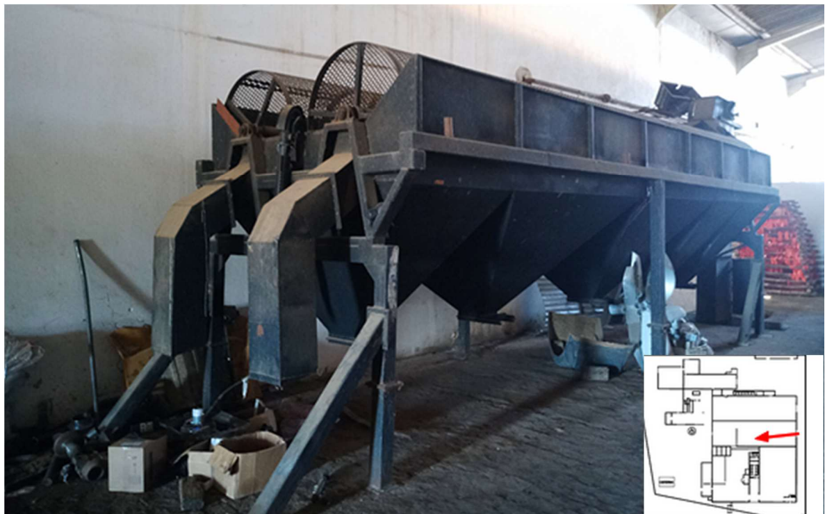
Figura 31 – Cilindro rotativo (peneira) classificador de grãos.
