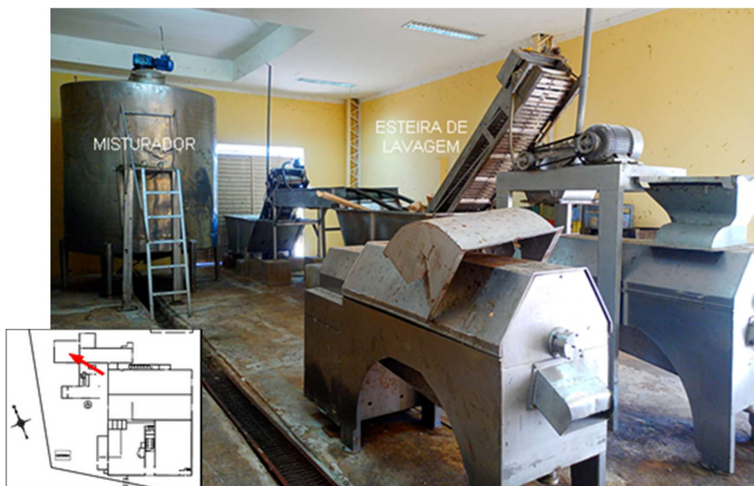
Figura 15 – Misturador e esteira de aço inox para lavagem.
